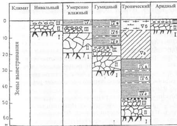
Рис. 3.11. Схема строения кор выветривания в различных климатических зонах (по В. В. Ершову и др., 1986)
