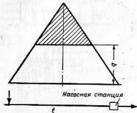
Фиг. 102. График для определения объема резервуара
