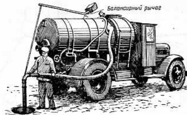
Рис. 121. Илосос „Промет-37“ в момент очистки колодца
