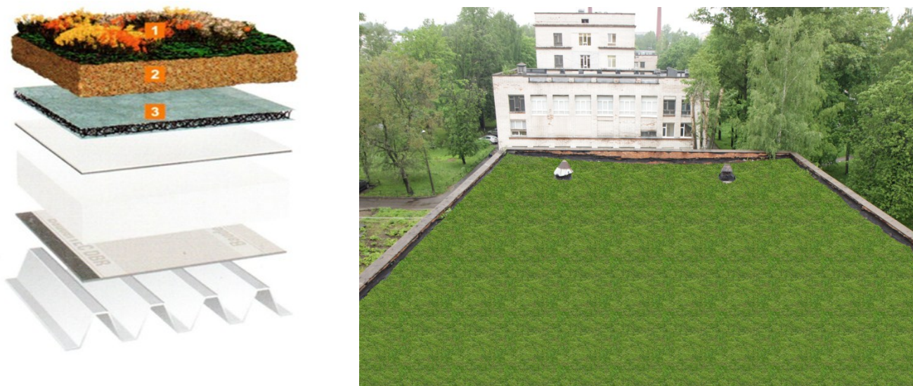
Рис. 3-15. Слева - SDF-мат, справа - вид зеленой крыши после реконструкции (проект).
