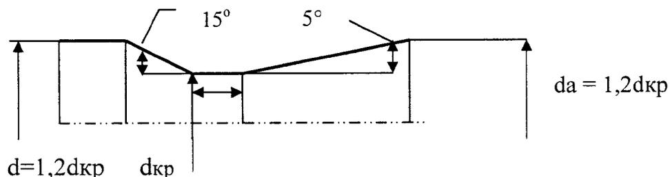
В.18.10. Диаметр критического сечения сопла насадка ( $D_{кр}$ , м) рассчитывается по формуле:
