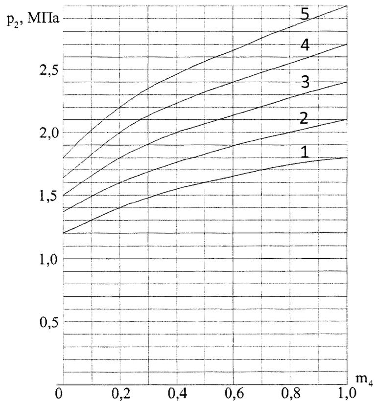
1 - при  $p_1 = 1,8$  МПа; 2 - при  $p_1 = 2,2$  МПа; 3 - при  $p_1 = 2,4$  МПа; 4 - при  $p_1 = 2,7$  МПа; 5 - при  $p_1 = 3,0$  МПа.
